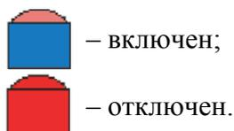
Условное обозначение насосной станции в зависимости от режима работы:
